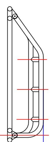
El largo del ponton se deberá adaptar de acuerdo al acuerdo al entre ejes del automóvil, respetando la separación máxima acotada respecto de los neumáticos.
