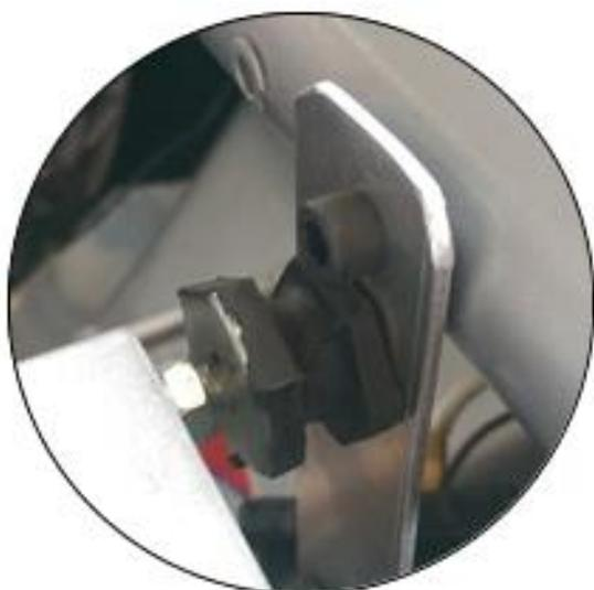
Se deben utilizar planchuelas o placas de sujeción entre el display y los silenblock. Es muy importante que la planchuela o placa de fijación al caño de la armadura de seguridad esté **sujeta de la parte superior e inferior** para evitar oscilaciones verticales que afectan los valores de aceleración que registra el sistema.
