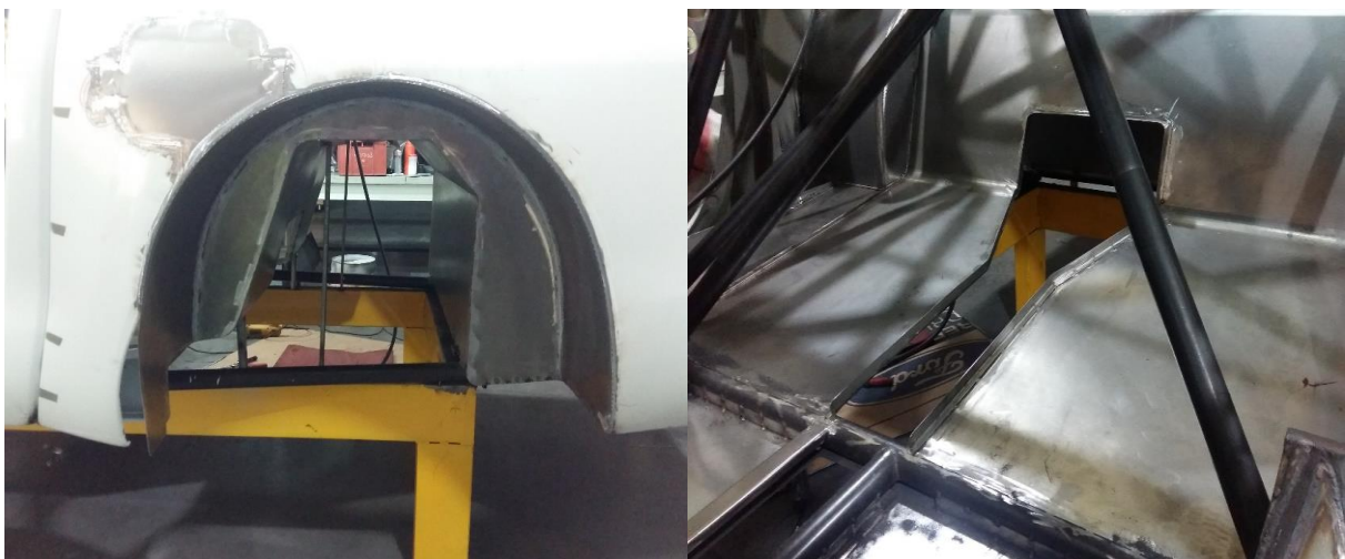
Salto de Diferencial vista lateral y vista desde el interior del habitáculo.
