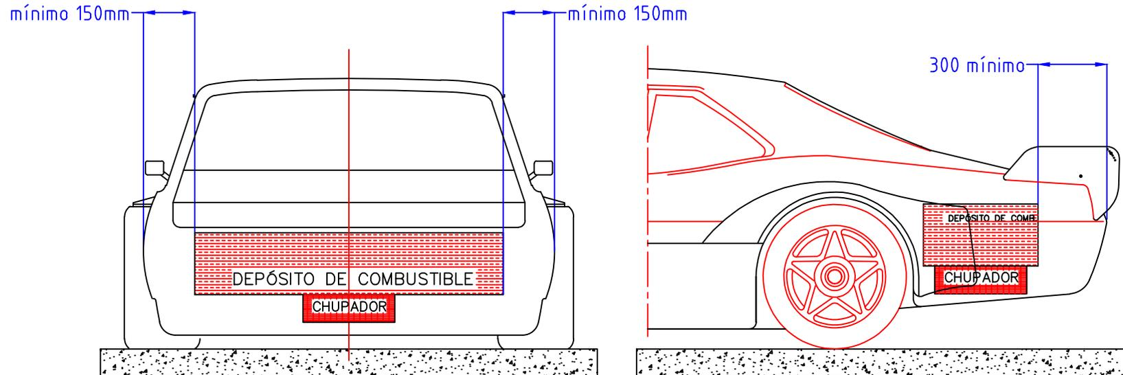
La fijación del depósito de combustible en relación a la altura del mismo es libre con la condición que él mismo como todos sus accesorios (chupador) estén en el interior del vano baúl.
