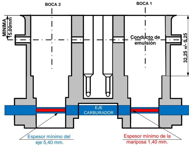
**INC.8:** El espesor mínimo del eje del carburador deberá ser de 5,40mm y el de las mariposas de 1,45mm; los tornillos de fijación son de libre diseño y dimensión.-
