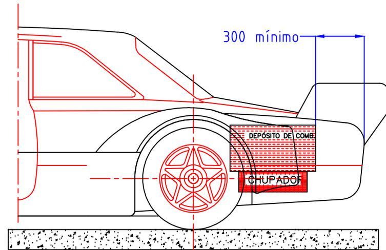
La fijación del depósito de combustible en relación a la altura del mismo es libre con la condición que él mismo como todos sus accesorios (chupador) estén en el interior del vano baúl.
