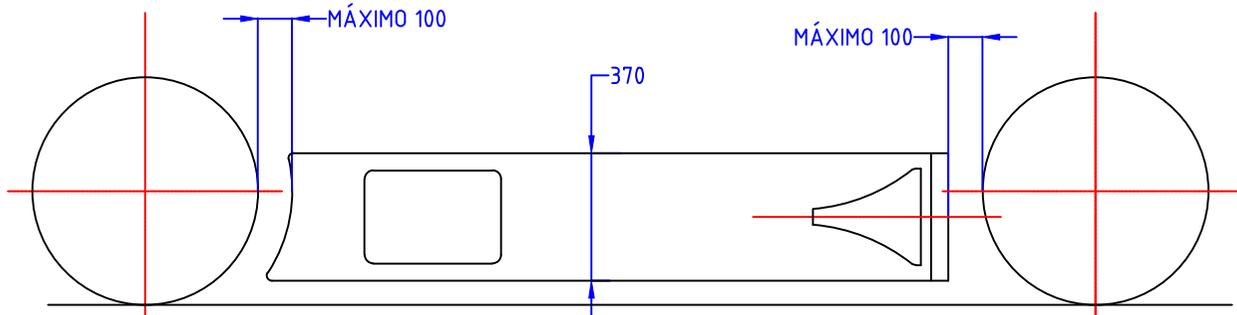
El largo del ponton se deberá adaptar de acuerdo al entre ejes del automóvil, respetando la separación máxima acotada respecto de los neumáticos.
