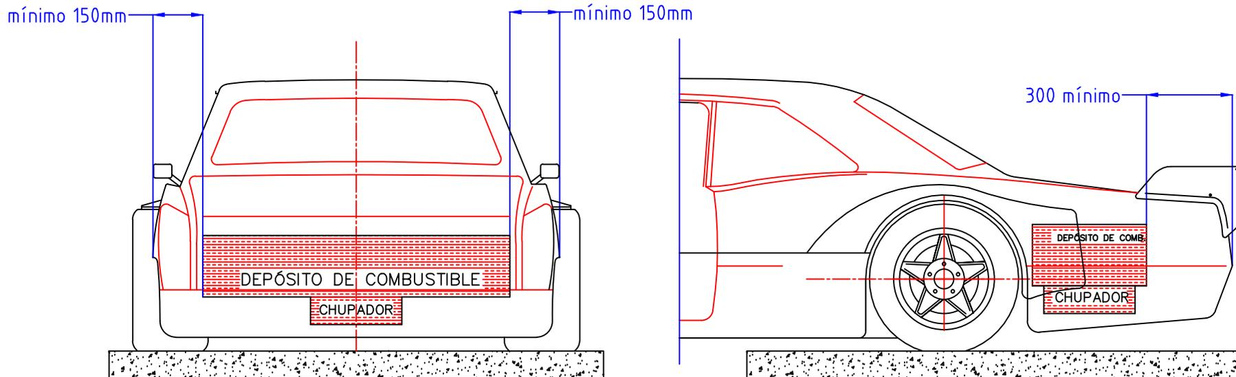
La fijación del depósito de combustible en relación a la altura del mismo es libre con la condición que él mismo como todos sus accesorios (chupador) estén en el interior del vano baúl.
