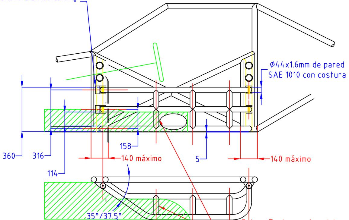
Este caño de empalme del lado del escape dejarlo para luego de ubicar la caja de aislamiento del escape, puede ir un caño curvo
