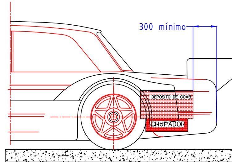
La fijación del depósito de combustible en relación a la altura del mismo es libre con la condición que él mismo como todos sus accesorios (chupador) estén en el interior del vano baúl.
