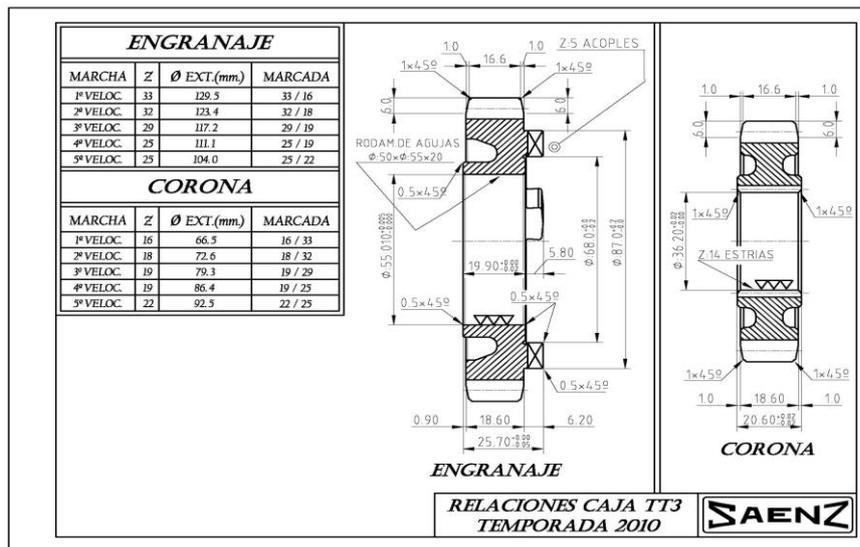
**INC 1:** La directa deberá respetar el plano adjunto y no se podrá utilizar ningún alargue en la misma como intermediario entre la caja y el motor.
