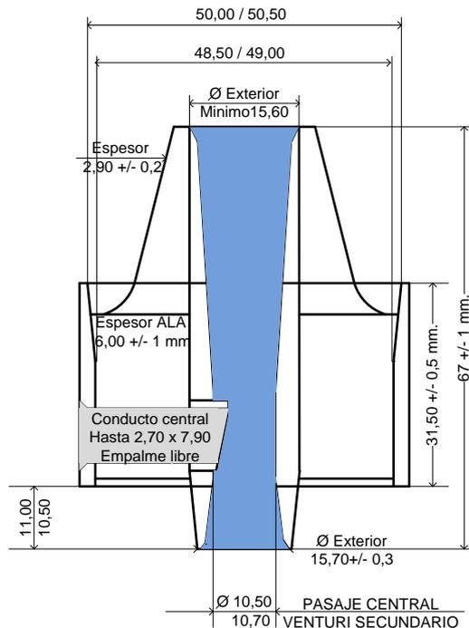
**INC.7:** Está permitido retirar los tapones de bronce del cuerpo de los carburadores 48/48 IDA para proceder al mecanizado y agregado de material con el solo objetivo de nivelar la altura de las perforaciones que descargan combustible en el conducto de los centradores.-La altura mínima del centro del canal de emulsión al apoyo de la tapa debe ser de 15 mm.-Ver esquema.-
