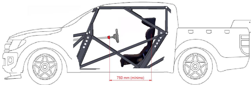
Figura 24.2.1 – Distancia mínima entre columna de dirección y butaca
